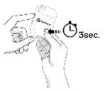
Pour éteindre l'appareil de téléassistance : Maintenir appuyées les touches APPEL et SOS ensemble pendant 3 secondes jusqu'à ce que les LED s'éteignent.
