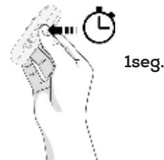
Para ligar o dispositivo: Premir o botão TELEFONAR durante 1 segundo, todos os LED irão piscar rapidamente. O dispositivo também pode ser ligado automaticamente colocando-o na estação de carregamento.
